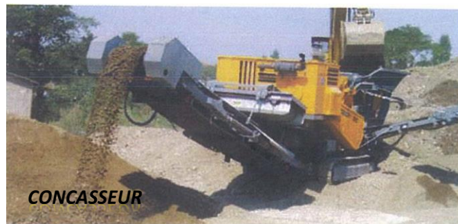
Figure 8 - Exemple d'installations mobiles pour le recyclage
